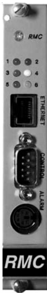
*Рис. 2. Передняя панель платы мониторинга и управления*
