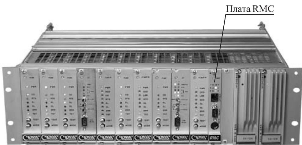
Рис. 1. Каркас с установленной платой RMC.
