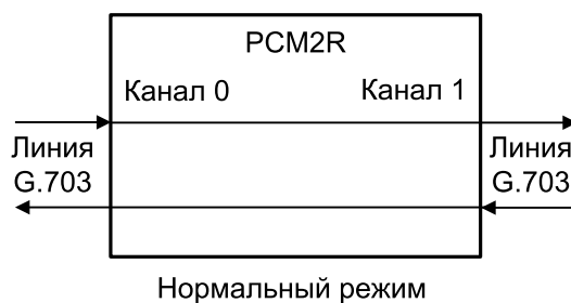
Рис. 4.2-1. Нормальное состояние (шлейфы не включены)
