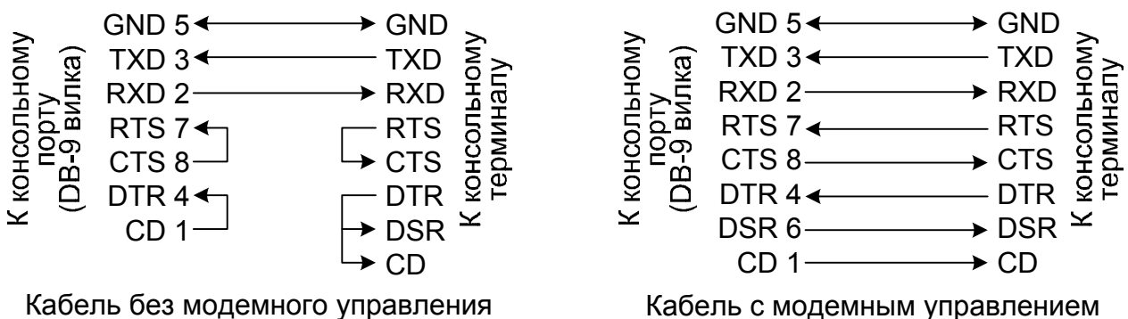
Рис. 2.4-6. Схемы консольных кабелей
