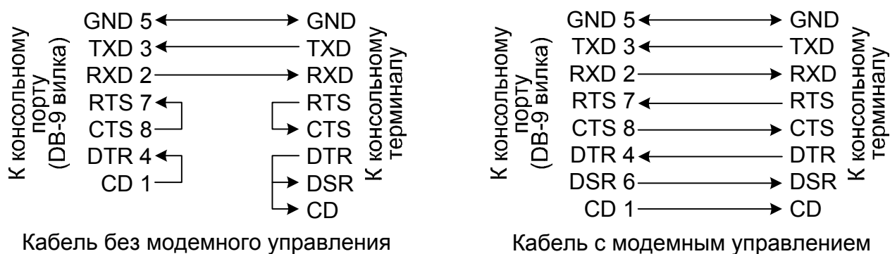
Рис. 3.3-9. Схемы консольных кабелей
