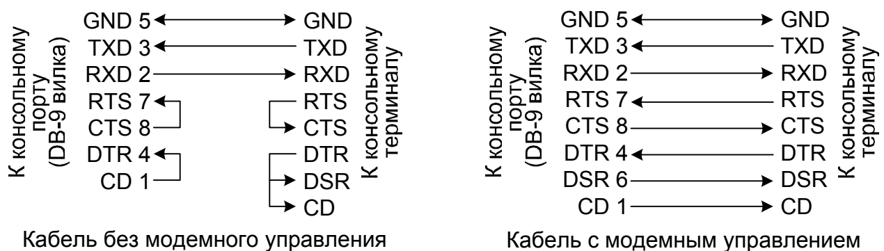
Рис. 3.2-4. Схемы консольных кабелей
