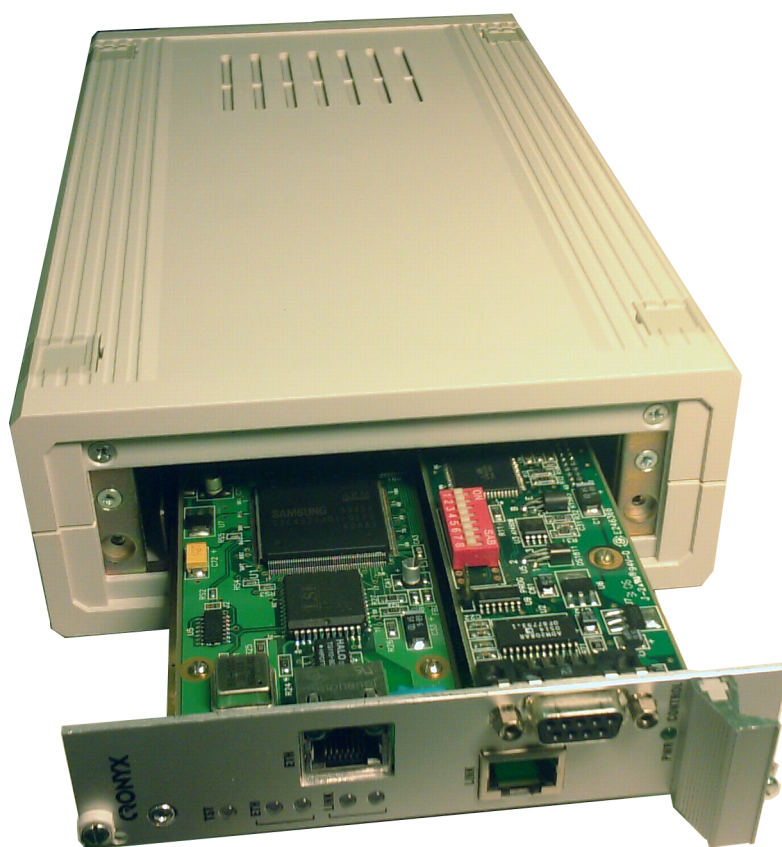
Шасси (вид спереди) с неполностью вставленным модулем исполнения /К.
